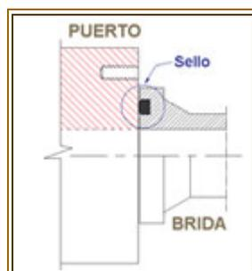
En el tipo Brida, el conector hembra (puerto) posee un orificio central sin rosca y cuatro orificios para pernos. El macho posee una cabeza de brida con un alojamiento para el o´ring.
